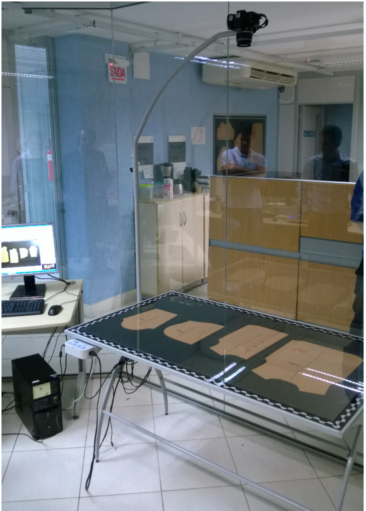
Ingeniería inversa. Esta máquina puede vectorizar patrones o prendas desmontadas con absoluta precisión: Desarrollo de
